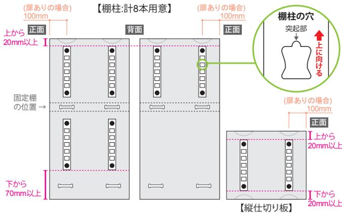
**2** 天板・地板・側板・固定棚・縦仕切り板のダボ穴にプラスチックダボをはめ込みます。
