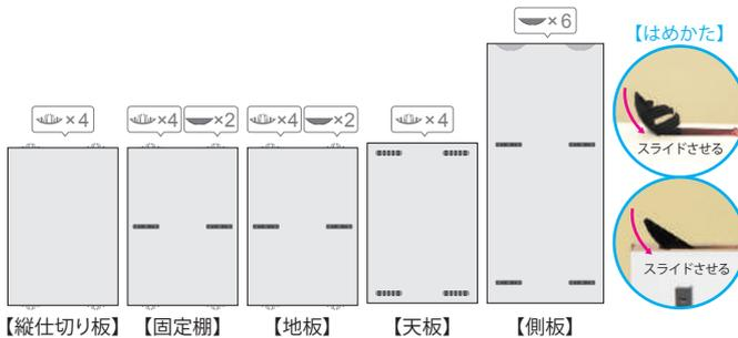
**3** 側板と縦仕切り板にハンガーパイプソケットを取り付けます。
