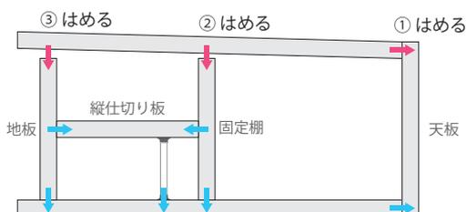
**5** 背面の三方2.5mm切欠き溝の中に背板(2mm小さい)を入れ底辺を揃えます。四方と固定棚・縦仕切り板の位置に釘やビス等で取り付けます。(100~150mmの等間隔)
