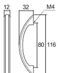
不要 <input type="checkbox"/><br>取付ねじ穴間隔=90<br>有効ねじ深さ=8 |
