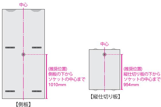
**4** 1枚目の側板に天板・地板・固定棚・パイプをはめた後縦仕切り板を固定棚・パイプ・地板の順にはめ、次に2枚目の側板を天板・固定棚・地板の順にはめます。接合部分は接着剤を併用してください。
