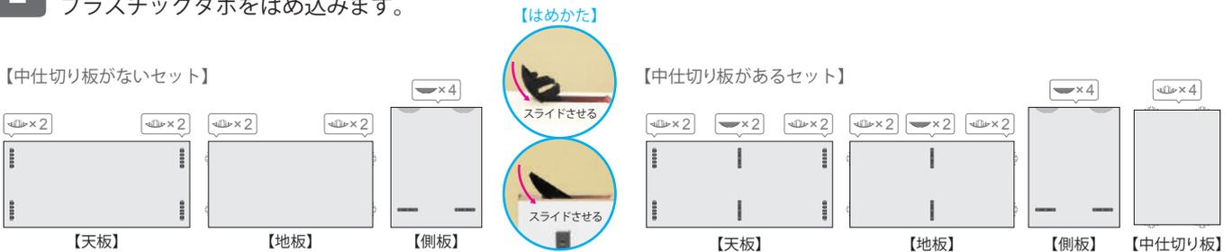
**3** 地板に側板2枚と中仕切り板をはめた後天板を側板・中仕切り板・側板の順にはめます。接合部分は接着剤を併用してください。
