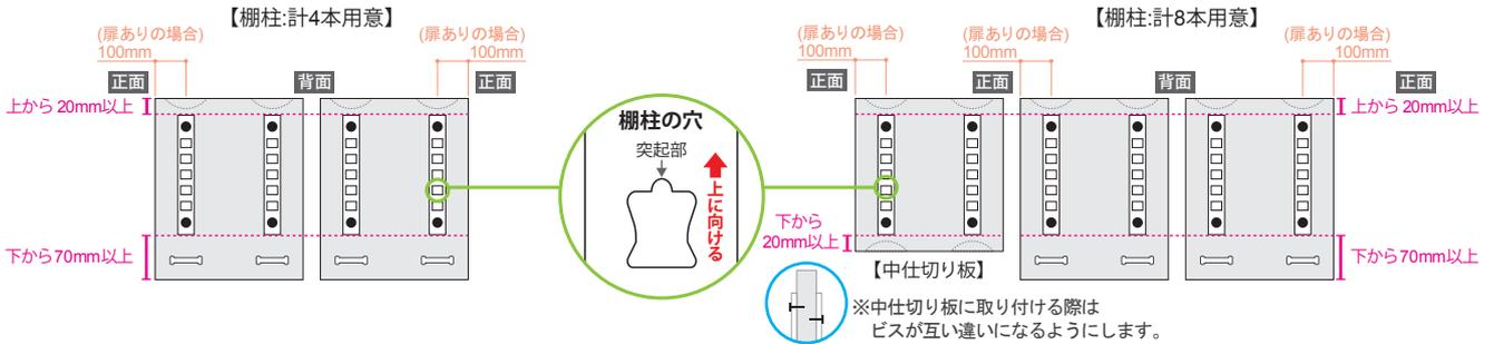
**2** 天板・地板・側板・中仕切り板のダボ穴にプラスチックダボをはめ込みます。
