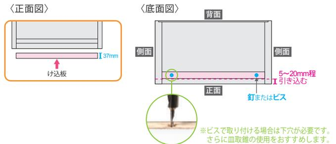
**4** 背面の三方2.5mm切欠き溝の中に背板(2mm小さい)を入れ底辺を揃えます。四方と中仕切り板の位置に釘やビス等で取り付けます。(100~150mmの等間隔)
